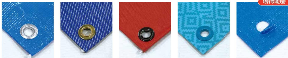
アルミハトメ 一般的なハトメです。 真鍮ハトメ 特に強度が求められるシートに使用されています。 黒ニッケルハトメ 高級感があるデザイン性と強度を兼ね備えたハトメです。 プラハトメ 廃棄時の分別が不要です。 ジョイントホール(内径13mm) 補強した生地に切り込みを入れて形成した止め穴です。分別不要でリサイクルしやすいだけでなく、アルミハトメと同等の強度があります。
