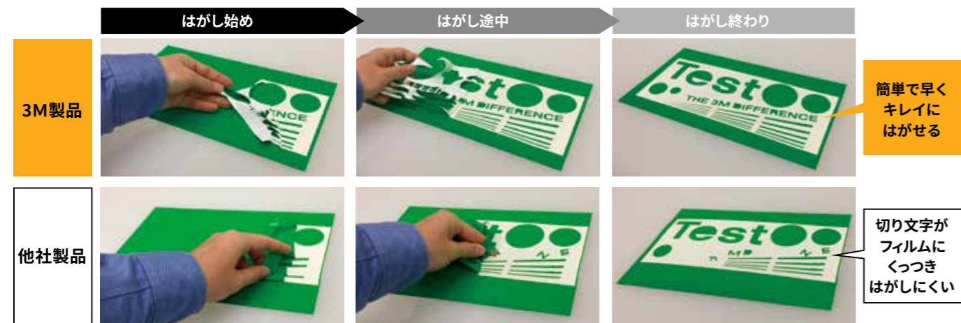
【カッティング性能試験条件】・プロッターで切り文字カット後10分間放置 ・片手のみで右上角から約300mm/分の速度でウインド ・サンプルサイズ：150mm×260mm
